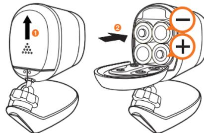
Encendido de la cámara para exteriores con baterías
