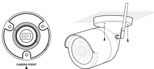
3. Fixe o suporte da câmera à parede usando os parafusos fornecidos.
