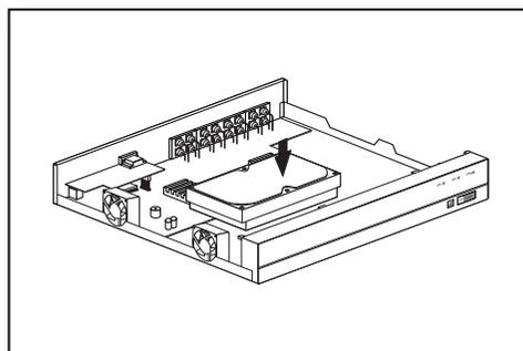
4. Am Boden der DVR stehen verschiedene Gruppen von Löchern für Befestigungsschrauben zur Verfügung. Fixieren Sie die Festplatte entsprechend der jeweiligen Größe mit den Schrauben.
