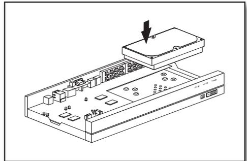
4. Am Boden der DVR stehen verschiedene Gruppen von Löchern für Befestigungsschrauben zur Verfügung. Fixieren Sie die Festplatte entsprechend der jeweiligen Größe mit den Schrauben.
