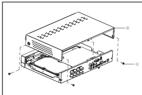
2. Connectez les câbles de données et d'alimentation du disque dur à la carte mère. Montez le disque dur en le montant sur le rack et en connectant les câbles d'alimentation et de données.
