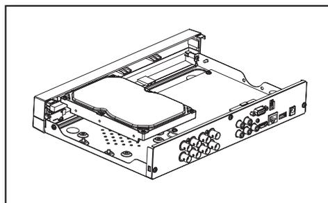
3. Plusieurs groupes de trous de fixation à vis sont fournis sur le bas de l'enregistreur numérique. Vissez le disque dur en place en fonction de la taille de votre disque dur.
